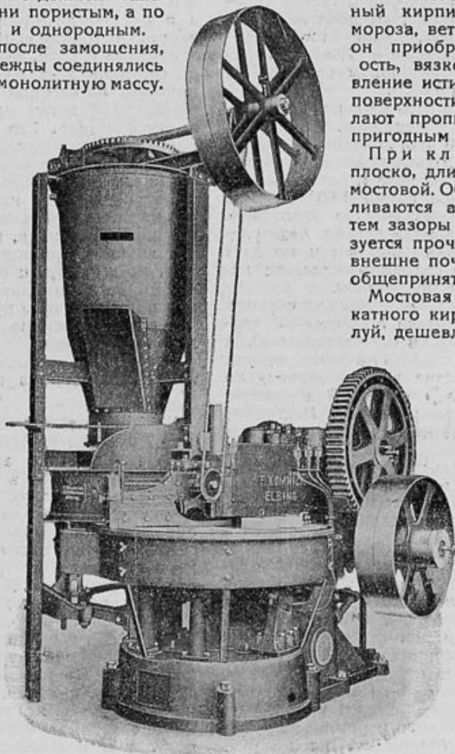
Пресс для изготовления силикатного кирпича. Пропускная способность этого пресса от 1.000 до 3.000 штук кирпича в час
